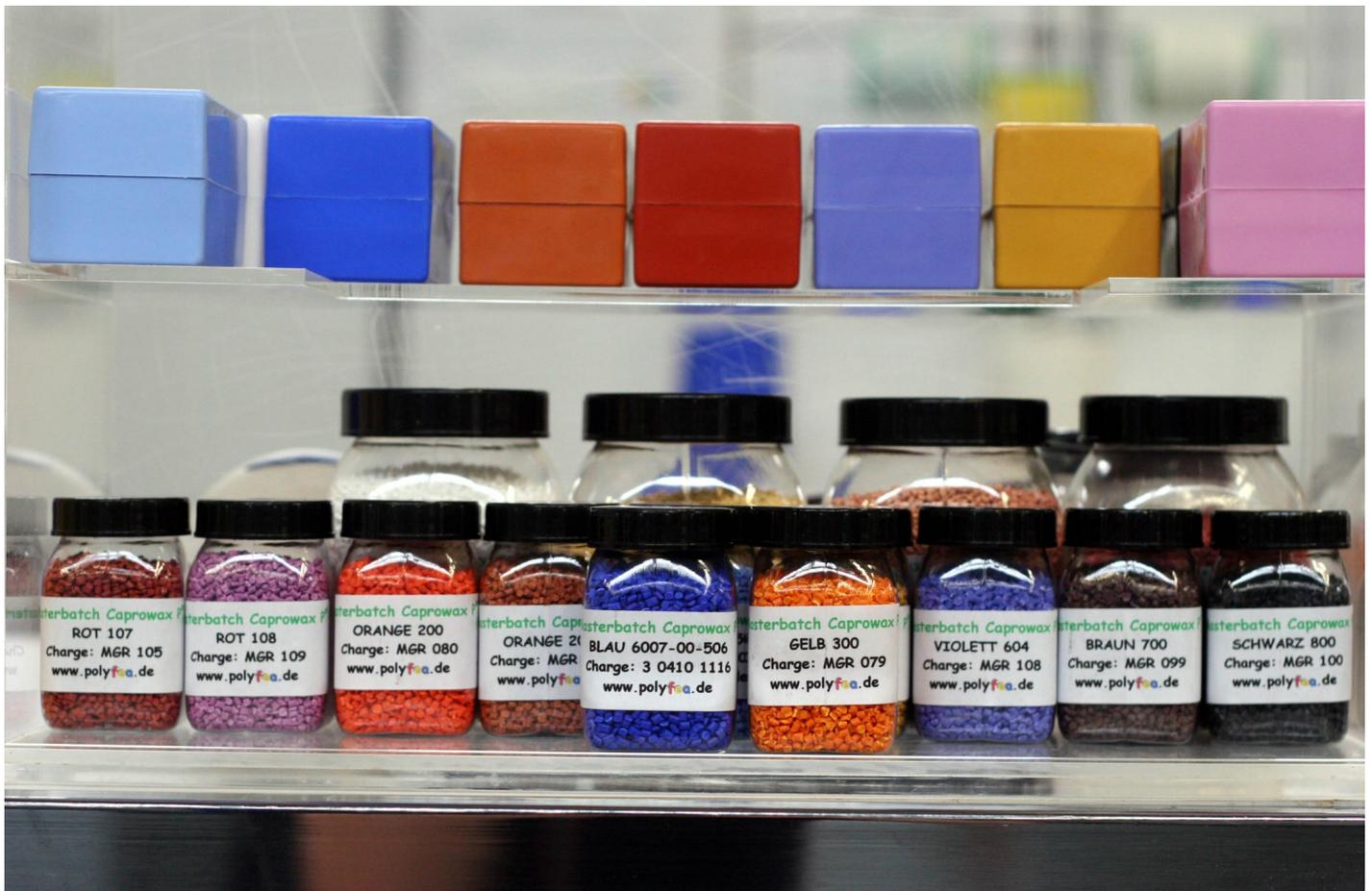
**Masterbatches** ohne Zugabe von TiO<sub>2</sub> für Biokunststoffe/Biocomposite/ Blends: PLA, PBS, PHA, PCL, **CAPROWAX P™/Blends/BioMineralComposite**, Polysaccharide/Derivate, Bio-NFC/WPC, Casein, PVAC/Blends, PVAL, Bio-TPE, Bio-UPR, NIPU. Das Trägermaterial auf Basis von **CAPROWAX P™ 6006** ist kompostierbar, wasserfest, entspricht den Vorgaben der DIN EN 13432.
